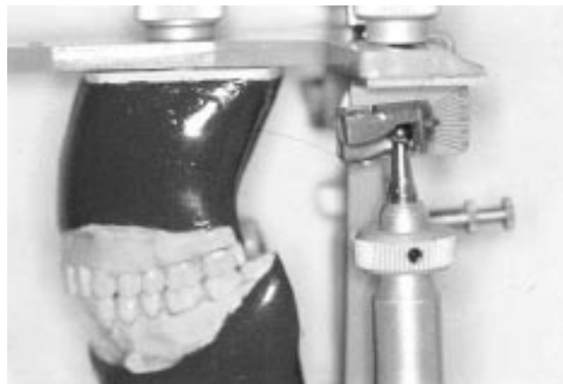
Figura 12. Obsérvese que en este tipo de articulador, gracias al uso del arco facial, la distancia eje de rotación-cóndilo es más aproximada a la realidad.
